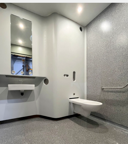
Toilet en wastafel van keramiek of roestvrij staal. Verhoogde achterwand. Antislip gepolierde betonnen vloer met hogedrukreinigingskoppen
